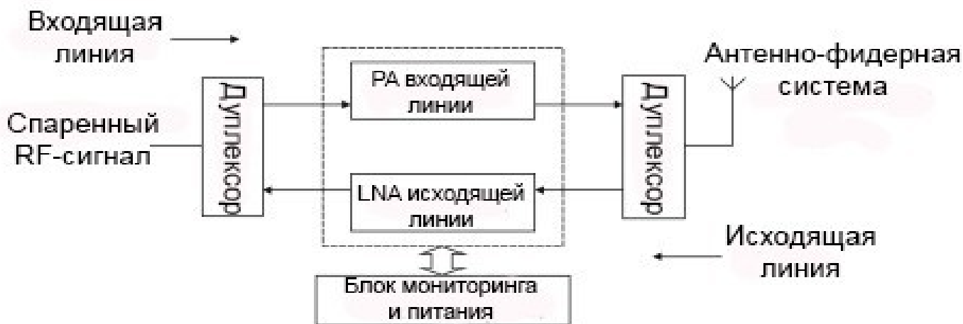
Рис. 1 - Блок-схема линейного усилителя
